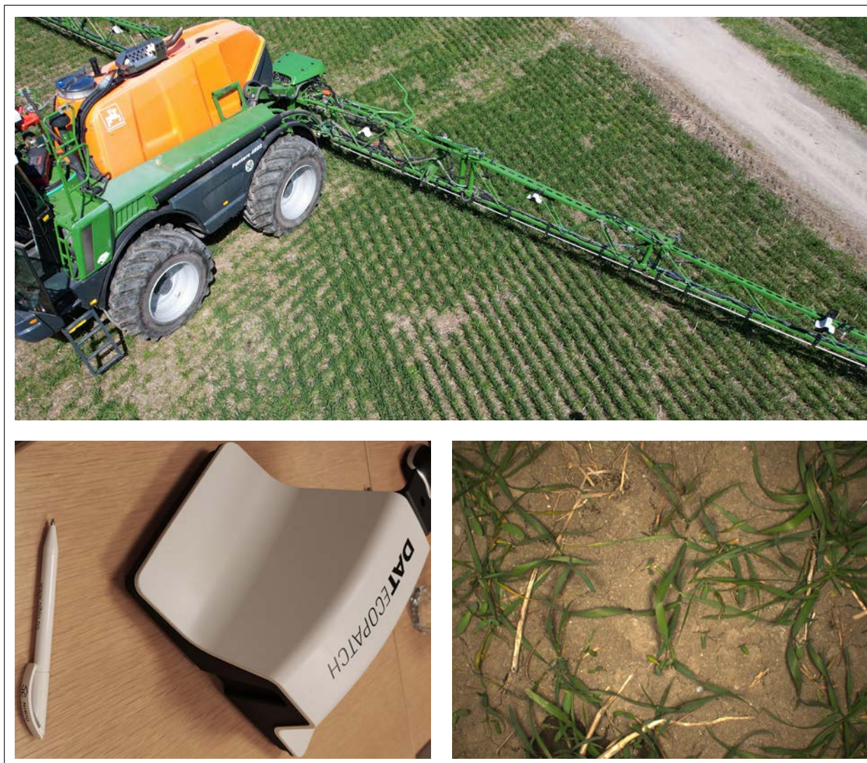
Bilde 1. Øverst: Kamerastyrt åkersprøyte for sprøyting av frøugras i korn (mai 2023, Østfold). I dette feltforsøket var det totalt åtte kameraenheter på bommen (30 m), på bildet synes fire av dem (Foto: Shahzad Zaman/Dimensions Agri Technologies AS). Venstre under: Nærbilde av kameraenhet (Foto: Therese W. Berge/NIBIO). Høyre under: Eksempelbilde tatt med åkersprøytekamera (Foto: Dimensions Agri Technologies AS).
